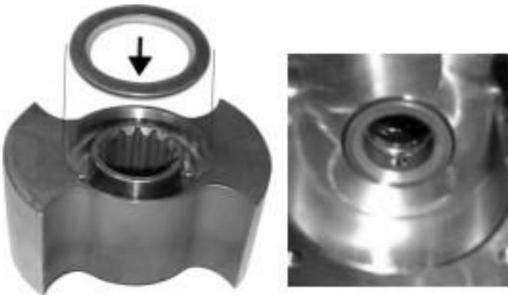
4. Montieren Sie den rotierenden Gleitring (7A) mit O-Ring (7B) im Rotor. **Hierbei ist darauf zu achten, dass die Mitnehmerstifte in die Aussparung des Gleitrings fallen!**
