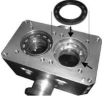
14. Montieren Sie ein Lagergehäuse (15) mit Innensechskantschrauben (14) im Pumpengehäuse.
