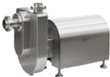
CPC-ZA Zelfaanzuigende roestvaststalen centrifugaalpomp Q max = 200 m 3 /h H max = 90 m
