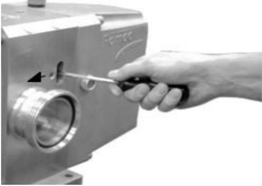
7. Stecken Sie beidseitig der Welle einen Schraubenzieher in die seitlich am Pumpengehäuse befindlichen Öffnungen; siehe Abbildung.
