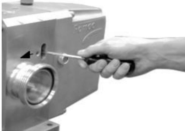
7. De part et d'autre de l'arbre, insérez un tournevis dans les orifices situés sur le côté du corps de la pompe (voir schéma).
