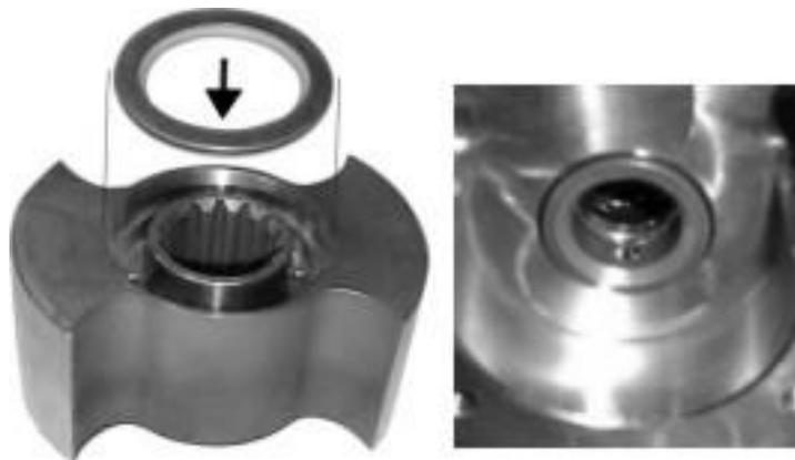
4. Montez la bague de frottement rotative (7A) avec le joint torique (7B) dans le rotor. **Veillez à ce que les ergots tombent dans la rainure de la bague de frottement !**
